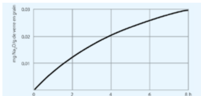
Attaque hydrolytique du DURAN® en fonction du temps (100°C)
